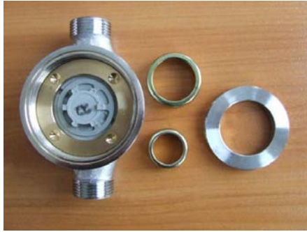
Rys. 3. Ekrany magnetyczne wodomierza suchobieźnego o podwyższonej odporności magnetycznej, nie wykazujące pozostałości magnetycznej przy pomiarze wskaźnikiem magnesów neodymowych
