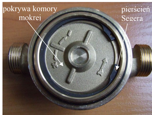
Rys. 1. Ferromagnetyczny pierścień Segera dociskający pokrywę komory mokrej wodomierza
