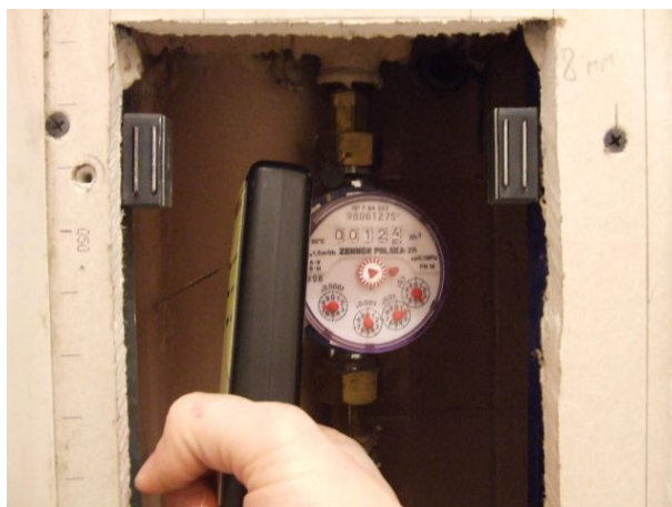
Rys. 7. Pomiar stanu namagnesowania wodomierza w zbyt bliskiej obecności obcego źródła pola magnetycznego (odległość pomiędzy magnesami d = 11,5 cm)
