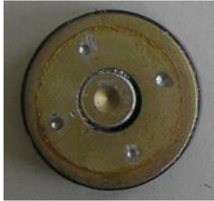
Rys. 9. Magnes ferrytowy pozyskany z głośnika; wartość natężenia pola magnetycznego na powierzchni H = 74 \text{ kA/m}
