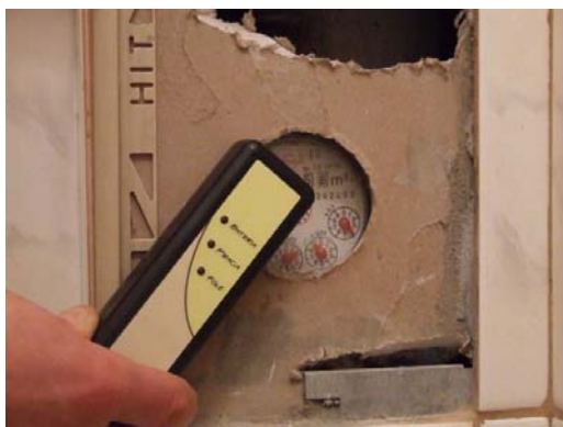
Rys. 2. Pomiar stanu namagnesowania wodomierza wskaźnikiem magnesów neodymowych
