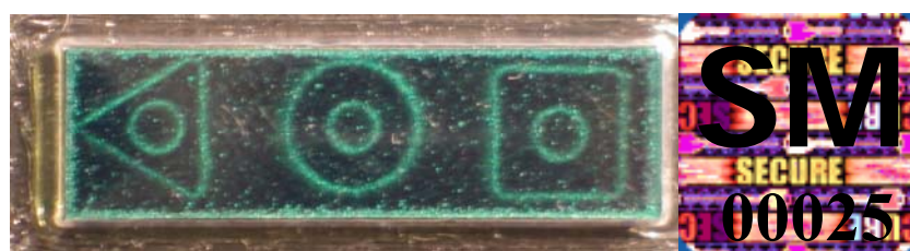
Rys. 11. Wskaźnik z elastomeru o strukturze magnetycznej w postaci znaków geometrycznych wraz z hologramem zabezpieczającym
