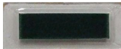
Wskaźnik po zadziałaniu pola magnetycznego o natężeniu powyżej 10 kA/m
